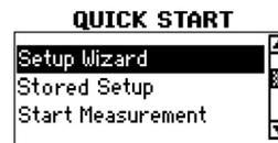
Wählen Sie den **Setup-Assistenten** mit den Pfeiltasten aus und bestätigen Sie mit **<ENTER>**. Wenn die Sensoren erkannt werden, wird die Seriennummer angezeigt. Wenn nicht, kann der Sensortyp ausgewählt werden.
