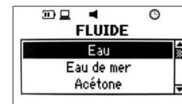
Choisir le fluide avec le clavier. Confirmer en appuyant sur **ENTER**. Pour un fluide non-standard choisir **Autre fluide**.
