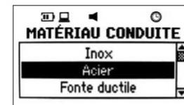
Choisir le matériau de la conduite avec le clavier. Confirmer en appuyant sur **ENTER**. Pour un matériau non-standard choisir **Autre tuyau**.
