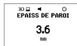
Des sondes de détection pour mesurer l'épaisseur de la paroi des tuyaux sont disponibles en option. Assurez-vous que le bon matériau de conduite est sélectionné. Connectez-vous à l'entrée du capteur et sélectionnez **Démarrer la mesure**.
