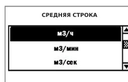
При помощи клавиш ▲ и ▼ выберите единицы измерения, подтвердите выбор нажатием ENTER. Выбранная единица измерения отобразится в середине экрана. Нажатие кнопки OFF деактивирует измерительный канал.
