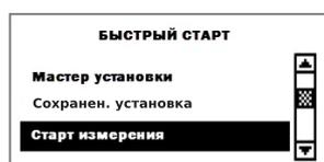
Для начала процесса размещения датчика выберите в меню **Старт измерения**. После активации обоих каналов, последуют измерения для **Канала 2**, а потом для **Канала 1**.
