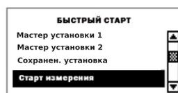
Выберите **Мастер установки 1** для установки 1-ого канала и **Мастер установки 2** для 2-ого. Подтвердите нажатием ENTER. Если датчики опознаны, серийный номер отобразится на дисплее. Если нет - датчик можно выбрать вручную.
