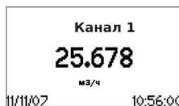
Основная единица измерений отображается при первом запуске. Кнопка **MUX** - переключение между каналами 1 и 2. Нажмите **NEXT** для вывода до трех единиц измерения на экран. Установка двух дополнительных единиц измерения - **Главное Меню - Вход-выход - Дисплей - Канал 1/ Канал 2**.
