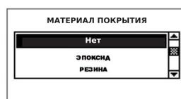
Выберите материал покрытия трубы клавишами ▲ и ▼, подтвердите выбор нажатием ENTER. При выборе данного материала появится дополнительный экран, который позволяет ввести значение толщины слоя.
