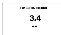
Введите значение толщины стенки трубы при помощи клавиатуры и ENTER. Кнопка ▲ используется для корректировки введенного значения.
