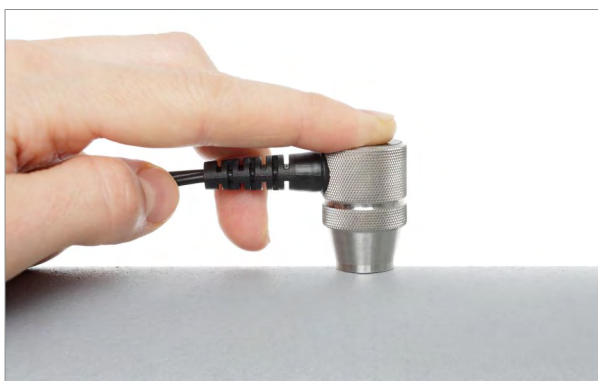
Jauge d'épaisseur de paroi NT en cours d'utilisation
