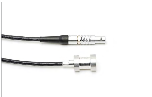
Transducteur Pt 100 à poste fixe sur conduite
