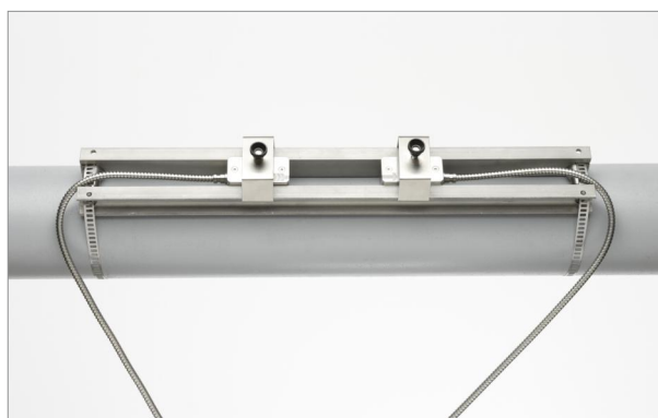
金属扎带和导轨安装换能器
