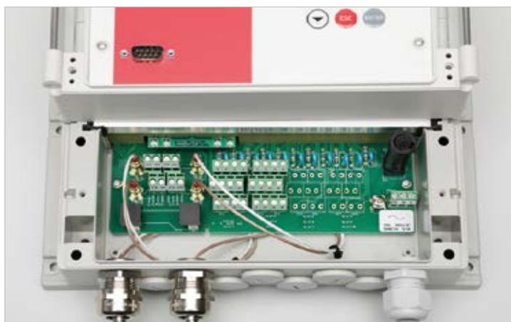
Le KATflow 150 offre un fonctionnement pratique et simple grâce à son boîtier attractif, son couvercle verrouillable et ses transducteurs en acier inoxydable. Il dispose de dix emplacements d'entrée/sortie qui peuvent être configurés individuellement.
