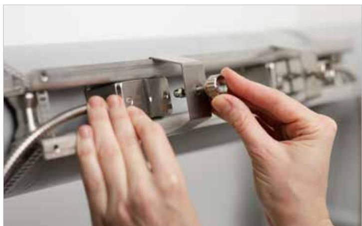
Der einfach zu bedienende KATflow 150 mit praktischem Polycarbonat-Gehäuse, leicht abnehm- und verschließbarem Deckel und Edelstahl-Sensoren zur Festinstallation an der Wand. Eine Metallmontageschiene garantiert die präzise Ausrichtung der Sensoren am Rohr.
