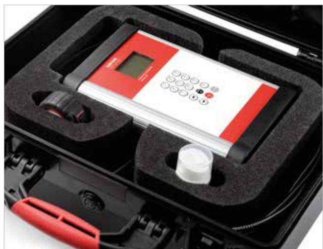
Der multifunktionale KATflow 230 mit K1N-Sensoren und Montagezubehör, der schnell und sicher verpackt im handlichen Koffer transportiert werden kann. Mit zusätzlichen Clamp-on-Temperatursensoren kann er auch für Wärmeenergiemessungen genutzt werden.
