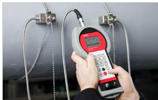
KATflow 200 utilisé avec les capteurs K1N installés.
