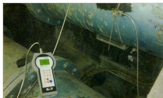
KATflow 200 installé sur une canalisation d'égout de gros diamètre.
