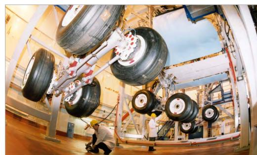
Banc d'essai du train d'atterrissage d'Airbus UK: des capteurs ont été installés pour mesurer le débit de l'huile hydraulique dans les trains d'atterrissage.
