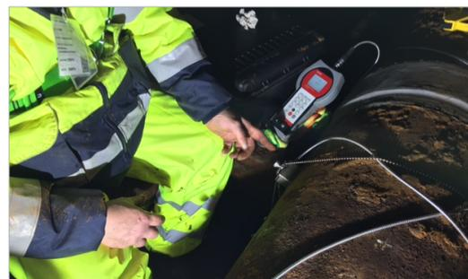
Der handliche KATflow 200 eignete sich hervorragend für die Testmessungen auf engem Raum unterhalb der Landebahn.
