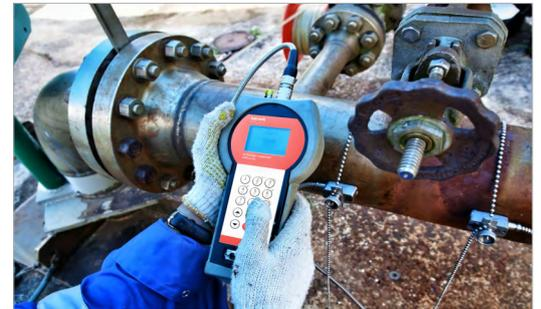
Supra Indodrill benötigte ein nichtinvasives Messgerät zur Volumenstrommessung von Wasser in Indonesien.
