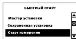
Для измерения выберите **Мастер установки**. При определении датчика отобразится его серийный номер. Если автоматического определения не произошло, датчик можно выбрать вручную.
