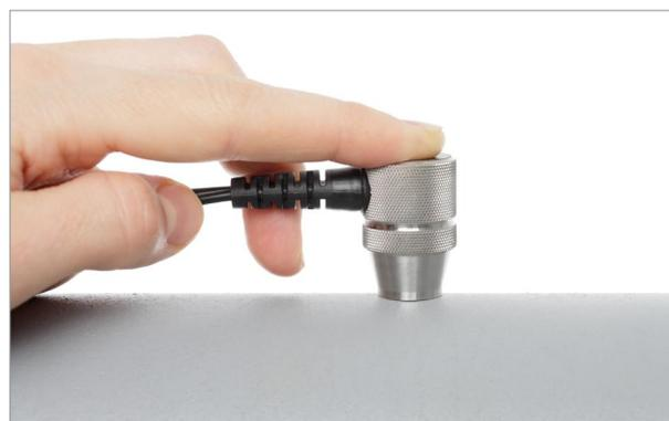
Зонд-толщиномер типа NT в использовании
