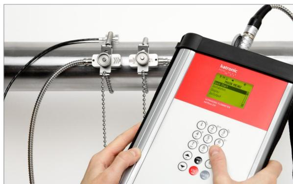
KATflow 230 с температурным датчиком типа PT100
