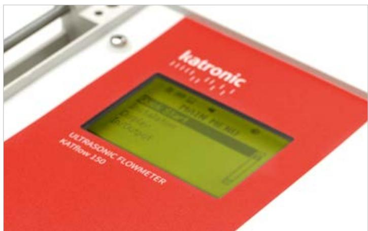
Монтируемый на стене KATflow 150 предлагает удобное и простое применение, обладает привлекательным корпусом с запирающейся крышкой из поликарбоната и имеет датчики из нержавеющей стали.
