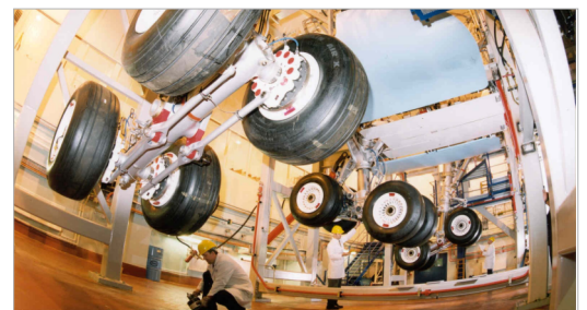
Airbus UK Fahrwerksteststand: Einsatz von Clamp-on-Sensoren zur Durchflussmessung des Hydrauliköls im Fahrwerk
